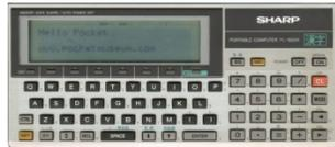
L'évolution ultime du PC-1500, avec un affichage multilingues, **deux processeurs** (un vrai Z80 et un LH5803 pour la compatibilité avec le PC-1500) un berceau comprenant une **table traçante 4 couleurs au format A4** et un **lecteur de disquettes**, des entrée/sorties **analogiques** etc.
